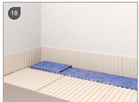
18 Tegellijm (EN12004C2) uitstroken: 20cm rondom de drain / Spread of the tile adhesive (EN 12004 C2): 20cm around the drain / Appliquer de la colle à carrelage (EN 12004 C2): 20 cm autour du drain / Um die Rinne im Bereich des Dichtungsvlies, 20cm Flexkleber EN 12004 C2 aufziehen
