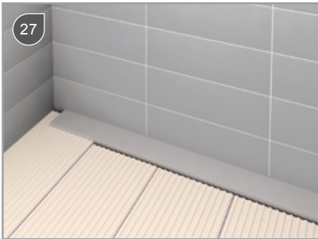
27 Tegellijm (EN 12004 C2) uitstrooien / Spread of the tile adhesive (EN 12004 C2) / Appliquer de la colle à carrelage (EN 12004 C2) / In der Duschfläche auf das Dichtungsvlies Flexkleber aufziehen
